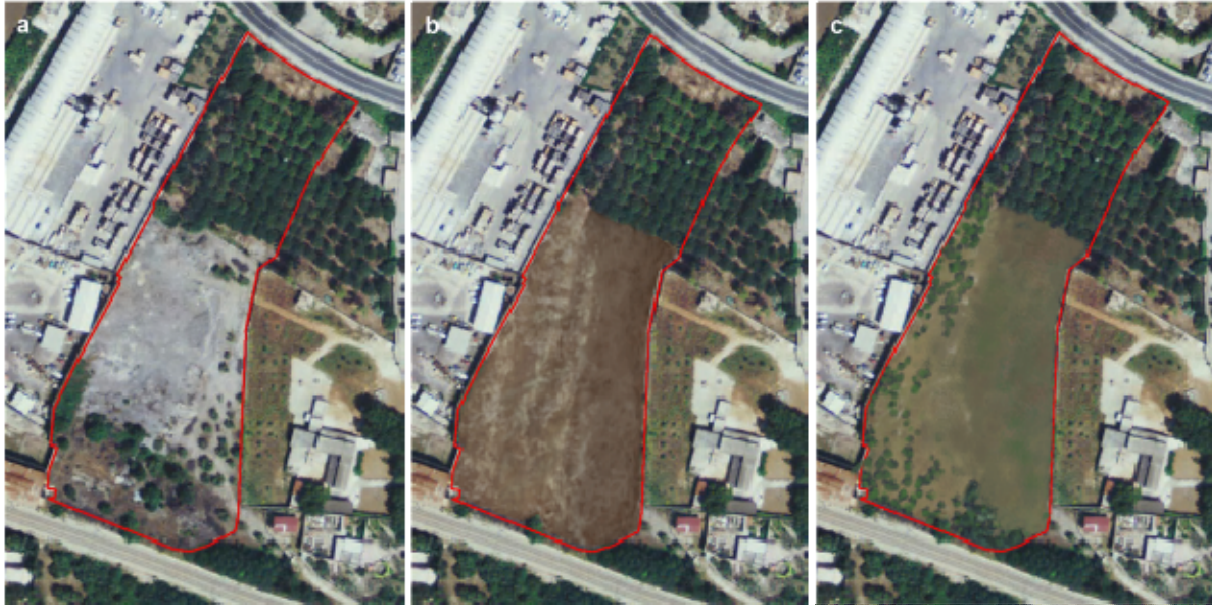
Figura 11: Planimetria dello stato dei luoghi prima dei lavori (a) e nella simulazione delle fasi successive agli interventi di ripristino morfologico (b) e di rinaturalizzazione (c).
