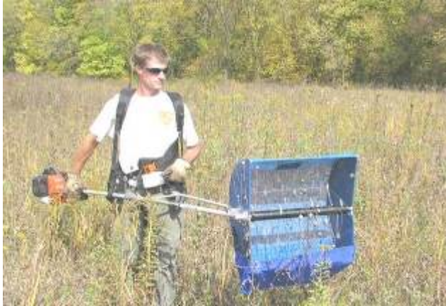
Figura 8: Esempio di macchina spazzolatrice a spalla.
