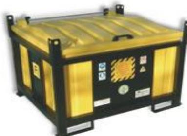
Per i Raee, raggruppamento 5 (ID22) si prevede l'utilizzo di un contenitore rettangolare in acciaio con portellone superiore incernierato, pallettizzazione strutturale, Big Bag interno asportabile, trattamento esterno anticorrosione ottenuto con resine poliuretaniche antiolio e antiacido di colore visibile e sicuro. Tale contenitore avrà capacità pari a 500 litri.
