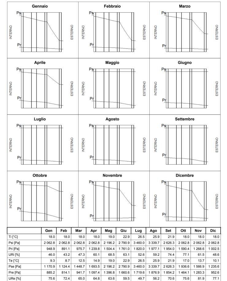
Ti = Temperatura interna; Psi = Pressione di saturazione interna; Pri = Pressione relativa interna; URi = Umidità relativa interna; Te = Temperatura esterna; Pse = Pressione di saturazione esterna; Pre = Pressione relativa esterna; URe = Umidità relativa esterna.
