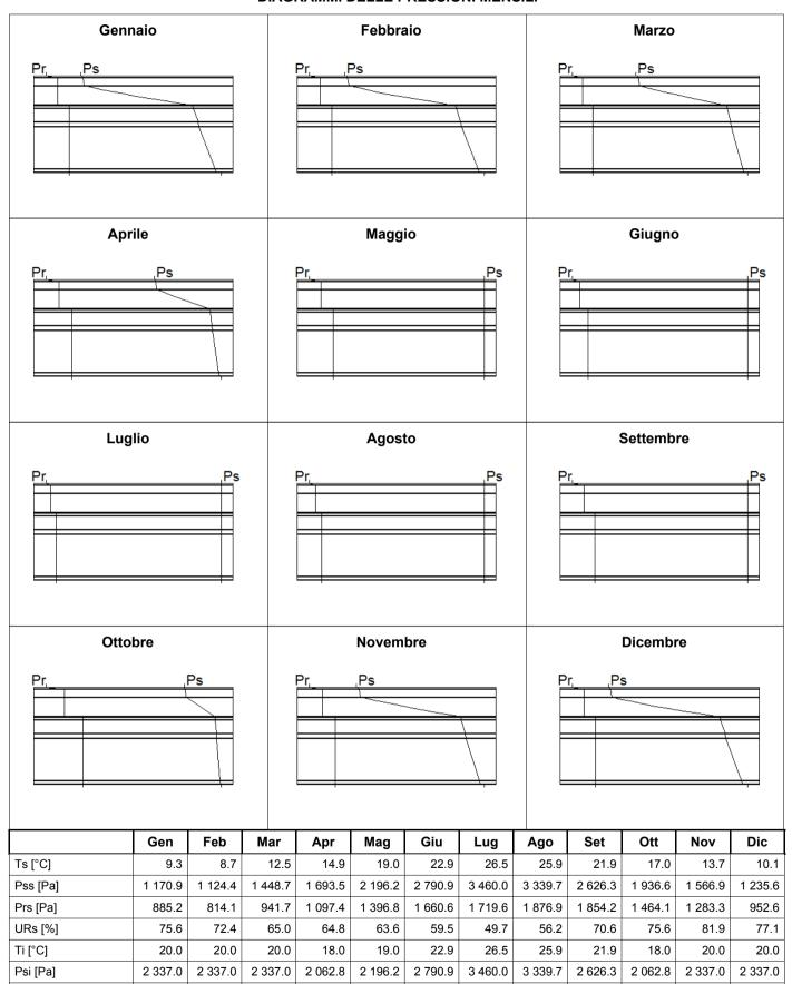
68.5 Ts = Temperatura superiore; Pss = Pressione di saturazione superiore; Prs = Pressione relativa superiore; URs = Umidità superiore; Ti = Temperatura inferiore; Psi = Pressione di saturazione inferiore; Pri = Pressione relativa inferiore; URi = Umidità inferiore.
