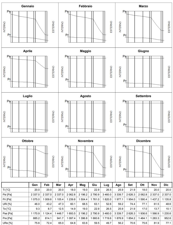
Ti = Temperatura interna; Psi = Pressione di saturazione interna; Pri = Pressione relativa interna; URi = Umidità relativa interna; Te = Temperatura esterna; Pse = Pressione di saturazione esterna; Pre = Pressione relativa esterna; URe = Umidità relativa esterna.
