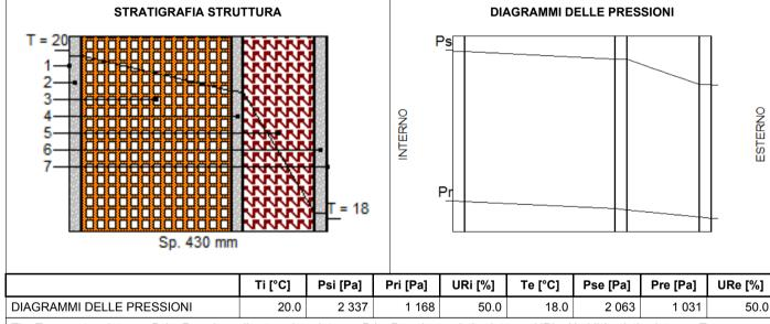
Ti = Temperatura interna; Psi = Pressione di saturazione interna; Pri = Pressione relativa interna; URi = Umidità relativa interna; Te = Temperatura esterna; Pse = Pressione di saturazione esterna; Pre = Pressione relativa esterna; URe = Umidità relativa esterna.
