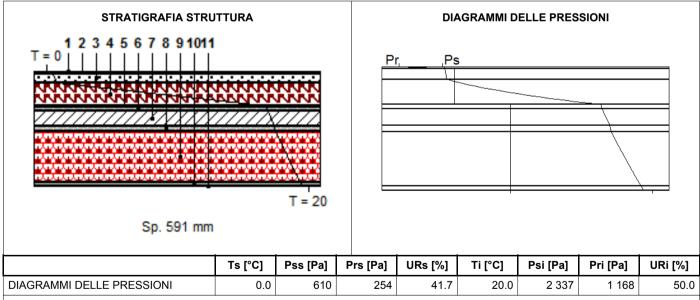
Ts = Temperatura superiore; Pss = Pressione di saturazione superiore; Prs = Pressione relativa superiore; URs = Umidità superiore; Ti = Temperatura inferiore; Psi = Pressione di saturazione inferiore; Pri = Pressione relativa inferiore; URi = Umidità inferiore.
