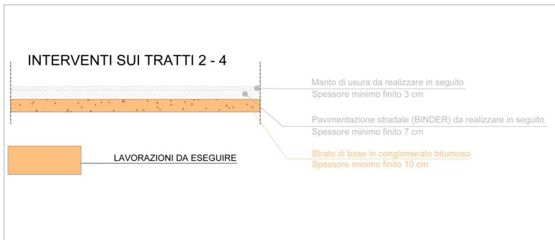
Il completamento del pacchetto stradale consistente nella posa in opera dello strato di binder dello spessore di 7 cm e nella posa in opera del manto stradale di usura dello spessore di 3 cm non è previsto nel presente progetto e sarà realizzato successivamente.
