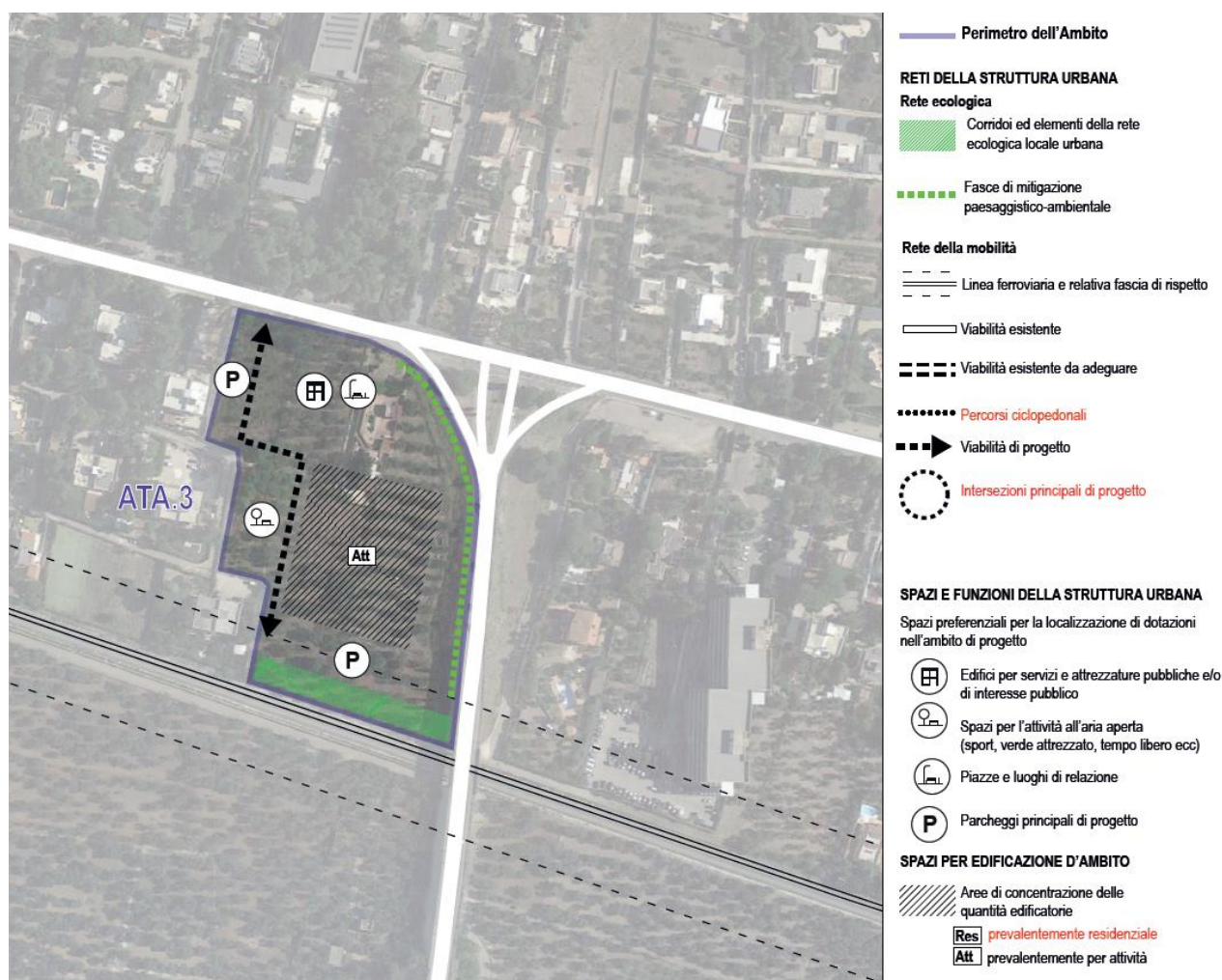
Fig. Stralcio Elab. PUG/P.2 Repertorio aree e ambiti – Schema di assetto per l'ambito di trasformazione di primo impianto prevalentemente per attività - ATA.3
