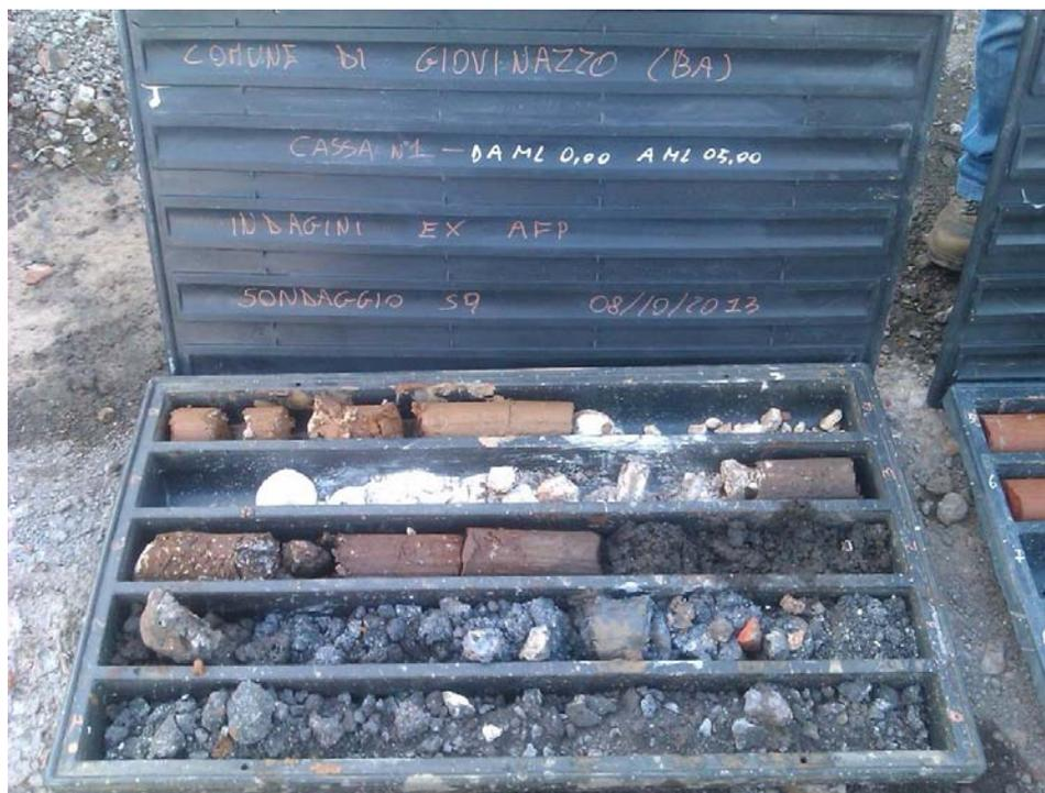
**Figura 6Cassette Catalogatrici Sondaggio S9, profondità 0-5 m.**
