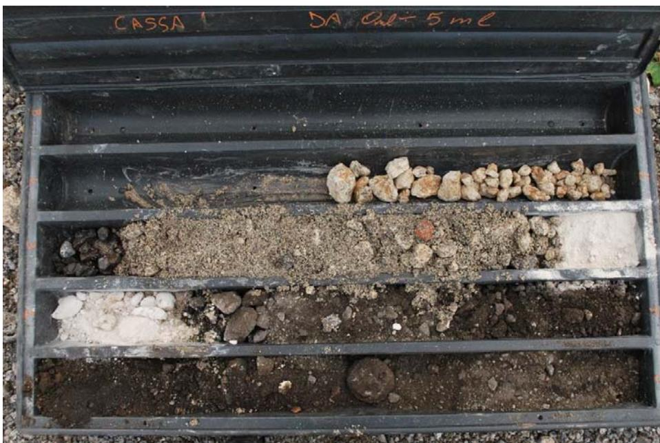
Figura 8 Cassette Catalogatrici Sondaggio S17, profondità 0-3,5 m
