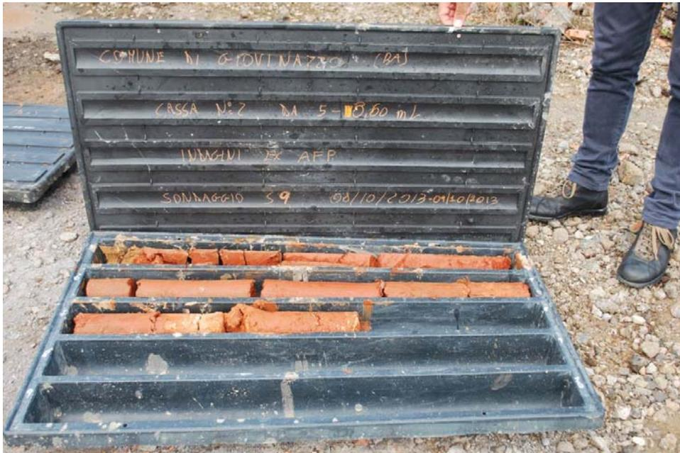
Figura 7 Cassette Catalogatrici Sondaggio S9, profondità 5-7,60 m.
